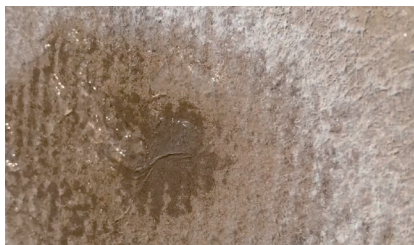
Ilustracja 2: Polimeryzacja czynnika chłodniczego
