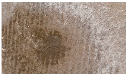
Иллюстрация 2: Полимеризованный хладагент
