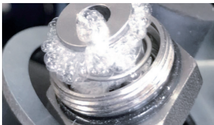
Иллюстрация 1: Полимеризованный хладагент в соединительном разъеме
