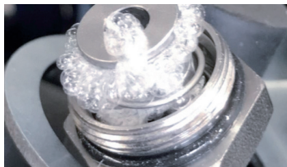
Ilustracja 1: Spolimerizowany czynnik chłodniczy w elemencie przyłączeniowym
