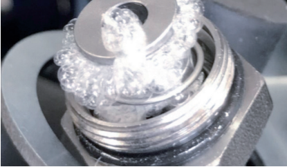
Resim 1: Bağlantı parçasındaki polimerize olmuş soğutucu madde
