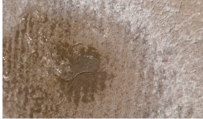
Resim 2: Polimerize olmuş soğutucu madde
